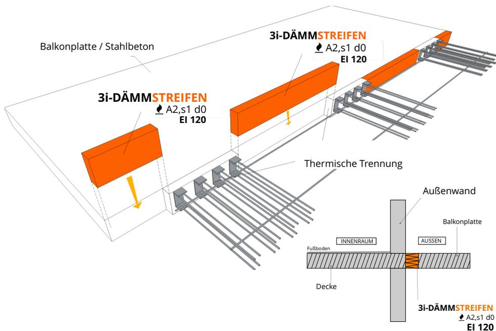
**3i-DÄMMSTREIFEN** eignen sich hervorragend zur thermischen Trennung bei Wandanschlüssen von z. B.: Balkone, Brüstungen, Konsolen, Loggien, Attiken uvm. Das Bau- und Anslusselement sorgt bei auskragenden Bauteilen für eine professionelle thermische Trennung. Somit werden Wärmebrücken insbesondere beim Anschluss von Balkonen vermindert.
